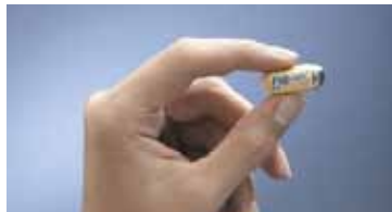
Pill-Cam™, 以色列 Given Imaging 公司发明的可以放入药丸以诊断肠道疾病的相机。
